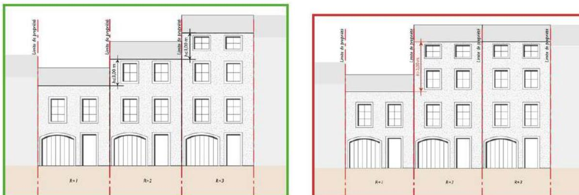
Schéma explicatif : Principes des hauteurs de construction
