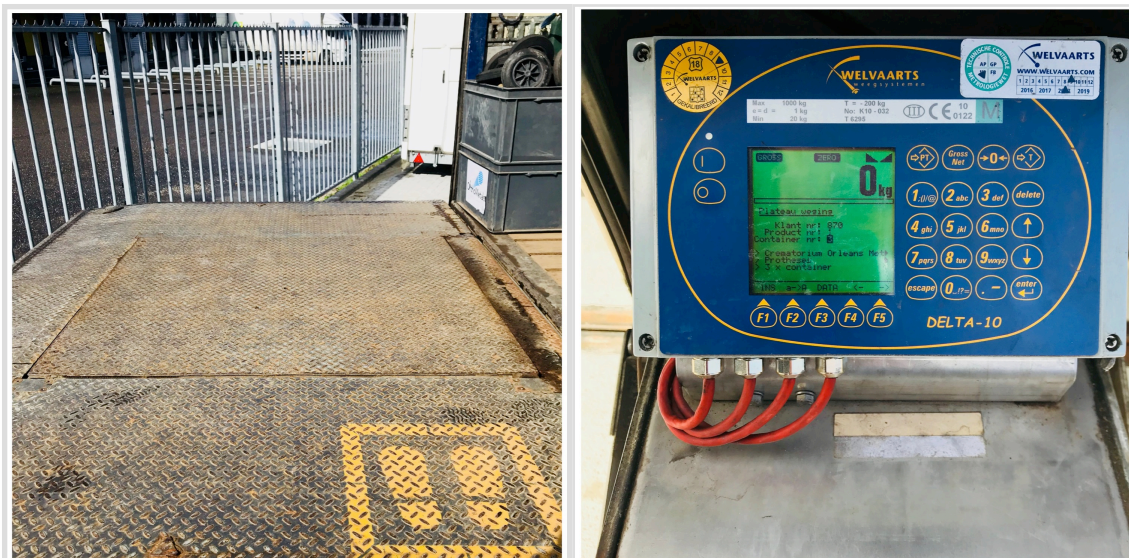
Haillon du camion avec la balance intégrée. À droite: Dispositif de pesage.
